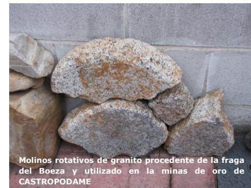
Molinos rotativos de granito procedente de la fraga del Boeza y utilizado en la minas de oro de CASTROPODAME
